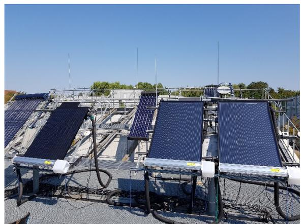
Unterschiedliche Photovoltaisch-Thermische (PVT)-Kollektoren auf dem Outdoor-Leistungsprüfstand des Labors für Solare Energiesysteme im Hochschultechnologiezentrum der htw saar (Foto: Danjana Theis)
