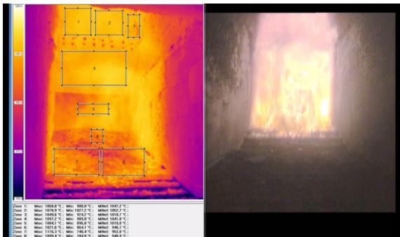
Gegenüberstellung von Video- und Infrarotaufnahme eines Verbrennungsrostes (eigenes Werk)
