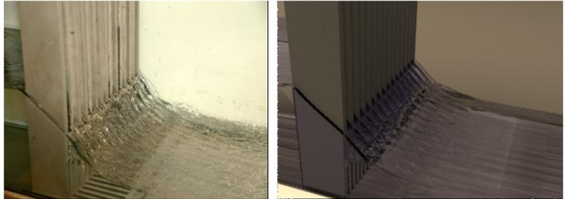
Abbildung 1: Experiment mit Feinrechen im Testkanal (links) und Simulation des Feinrechens (rechts)
