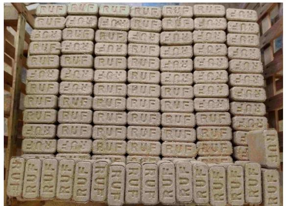
Eine Charge Briketts aus Haferschälkleie und Spänen (eigenes Werk)
