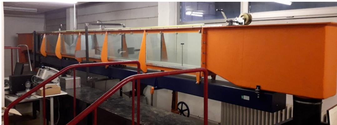
Abbildung 2: Testkanal der htwsaar für Experimente zum Strömungsverhalten von Kanal mit diversen Einbauten
