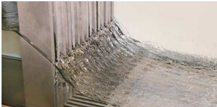
Abbildung 9: Vergleich der Strömung beim Rechenaustritt als Detailansicht aus dem Experiment (links) mit den visuell aufbereiteten Simulationsergebnissen (rechts)
