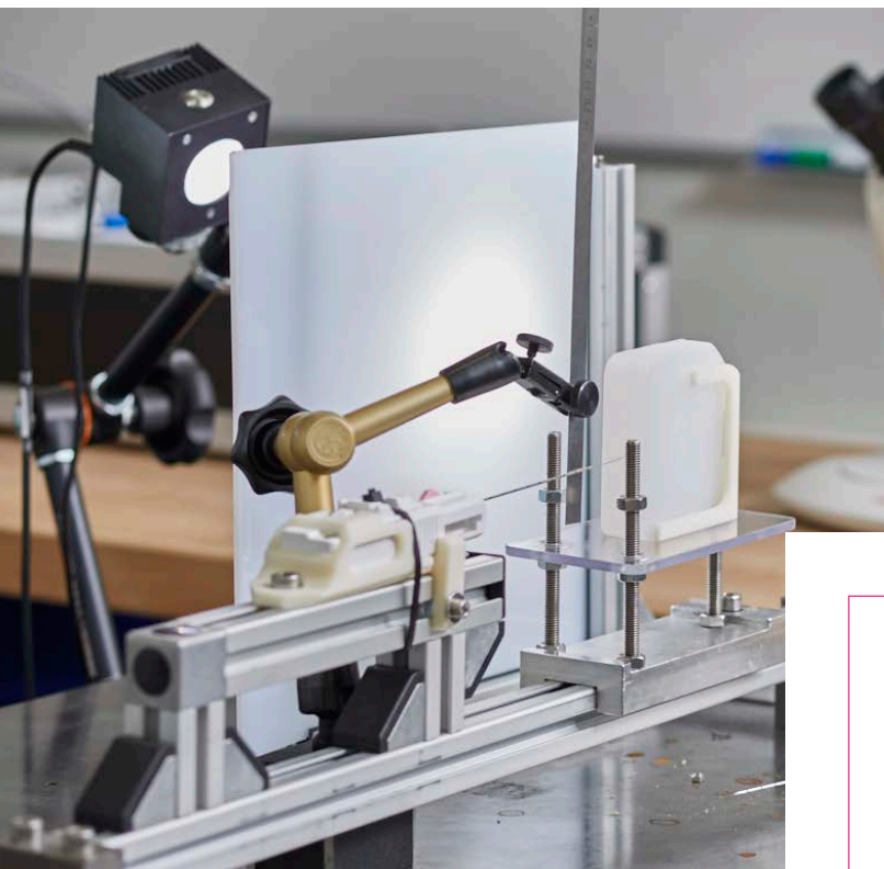
Abbildung 4: Versuchsmodell einer Feinnadelpunktion: Über einen Schlitten (Alu-Profil Bildmitte) dringt die Biopsienadel (Schlitten Bildmitte) in ein Gewebephantom (transparenter Block rechts) ein. Aufnahmen mit der High-Speed-Kamera lassen exakte Schlüsse zu, welche physikalischen Kräfte während des Schusses auf die Nadel einwirken und dazu führen, dass die Nadel abbiegt.
