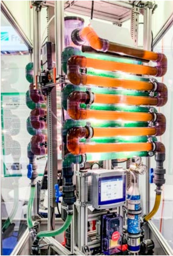
Abb. 3: 2-Kreislauf-Röhren-Photobioreaktor am CLUB-Messestand.
