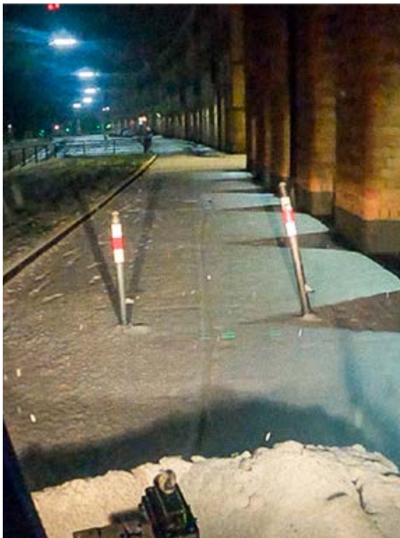
Abb. 2: Zu geringe Durchfahrtsbreite für das Winterdienst-Schmalspurfahrzeug.
