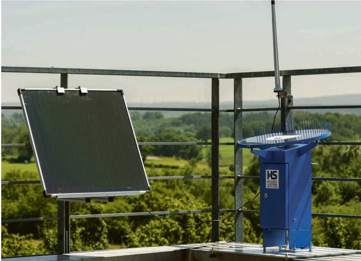
Hagelsensor HailSens mit Solarmodul
