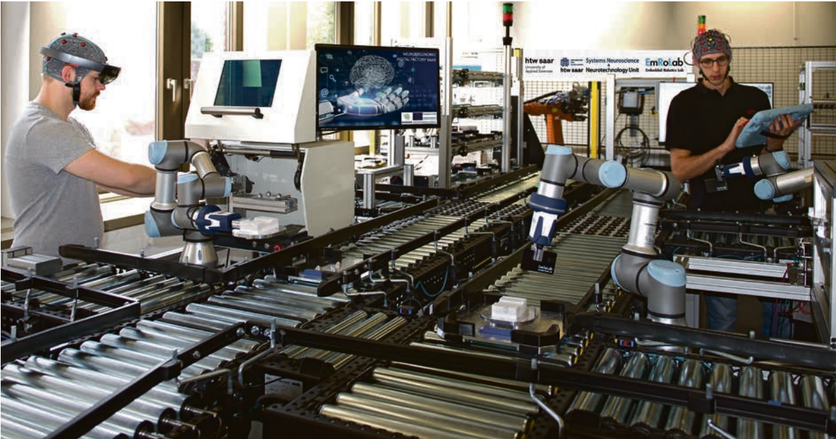
Mess- und Assistenzsysteme im Einsatz an kollaborativen Arbeitsplätzen in der Modellfabrik © Eric Wagner, EmRoLab
