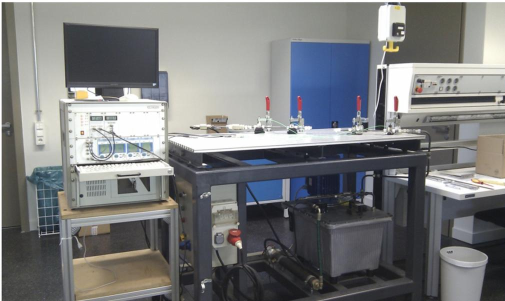
Abbildung 1.1.4: Der Prüfstand „Hose Expert 1.0“ – Messtechnik (links) und Prüftisch mit Aggregat
