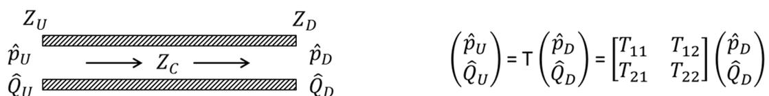
Abbildung 1.1.1: Vierpolmatrix eines Leitungselements
