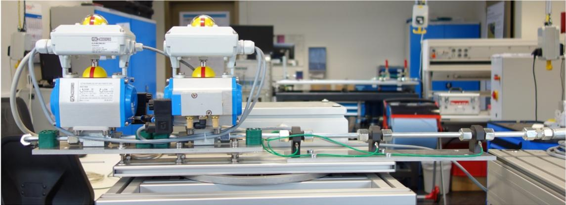
Abbildung 1.1.13: Abschlussseitige Referenzstrecke und pneumatisch betätigte Kugelhähne
