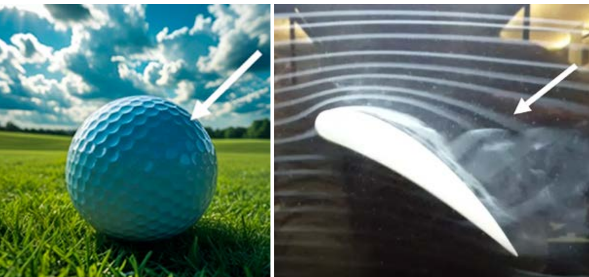
Abb. 3: Strukturen auf dem Golfball und Ablöseerscheinungen hinter dem Flügelprofil (Quelle: Frank U. Rückert)
