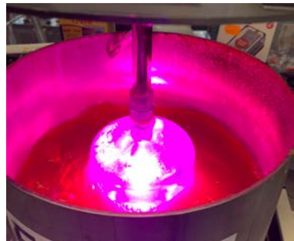
Abb. 2: Blick in einen Floating Light Ball Reaktor an der htw saar, in dem eine Lichtkugel in das Kulturmedium – hier mit der Alge Phaeodactylum tricornutum – eintaucht
