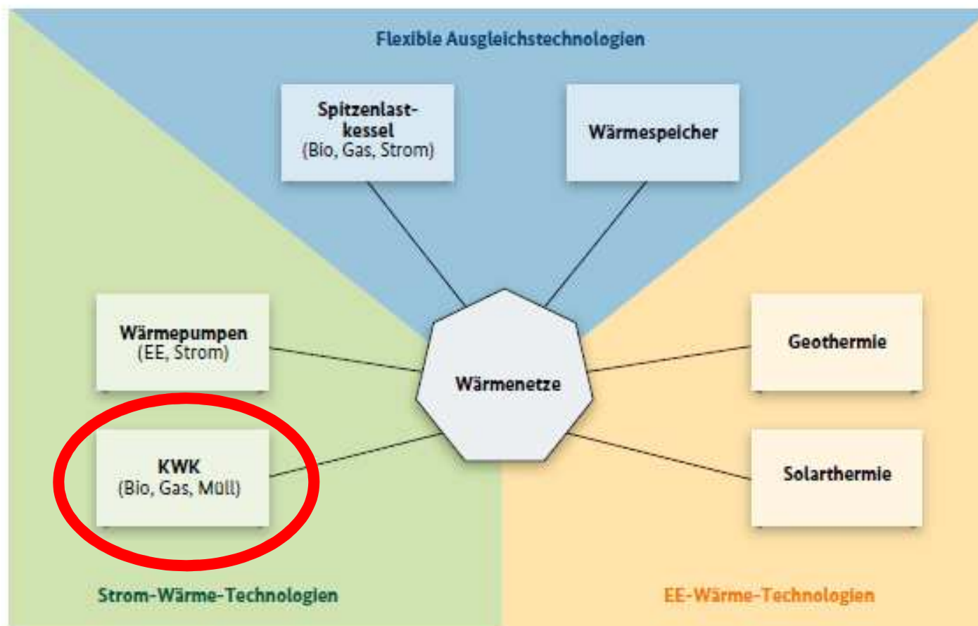
Abbildung 4: Wärmenetzbasiertes System an der Schnittstelle zwischen Strom- und Wärmesektor (schematische Darstellung)
