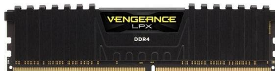
Abbildung 2.6: Arbeitsspeicher Corsair DIMM DDR4-2400 Vengeance LPX [Gei18c]
