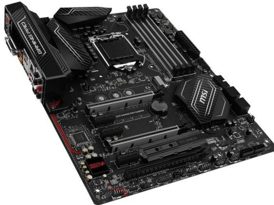
Abbildung 2.3: Mainboard MSI Z270 Gaming Pro Carbon [Gei18g]
