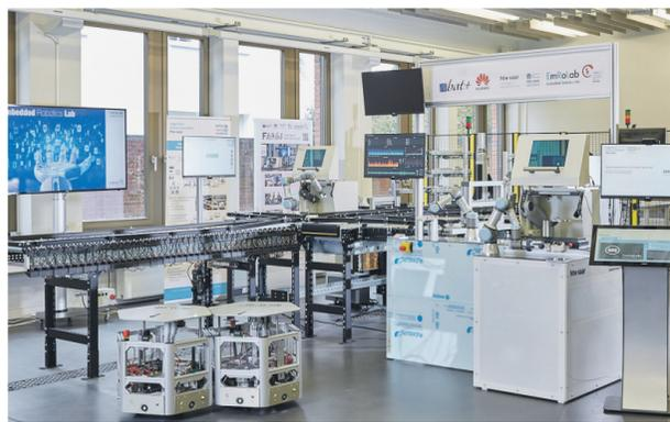
EmRoLab: Flexible Produktions-Plattform mit unterschiedlichen Fertigungs- und Bearbeitungsstationen rund um ein intelligentes Förderrollensystem
