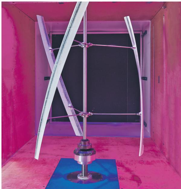
Vertikale Windturbinen im Windtunnel der htw saar
