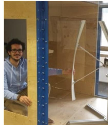
Bild 2: Fabrice Neumann mit einer im Göttinger Windkanal installierten vertikalen Kleinwindturbine (im Windenergielabor der htw saar)
