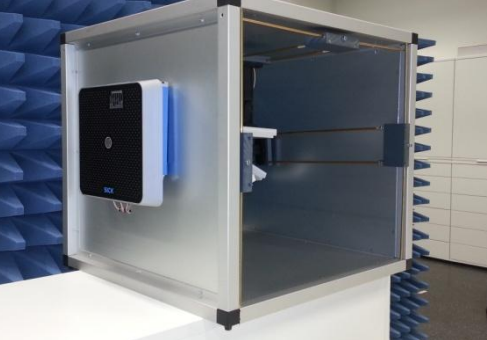
RFID Gate zur Erhöhung der Lesesicherheit bei hoher Packungsdichte (Medikamenten Blister) Projektpartner Phast
