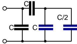
2. Zusammenfassung wg. Parallelschaltung zweier Kondensatoren:
