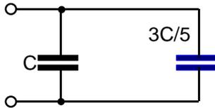
4. Nun Parallelschaltung zweier Kondensatoren:
