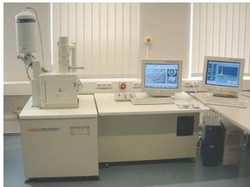
Das Rasterelektronenmikroskop 6460LV der Firma JEOL ist ein Mikroskop mit einer ungewöhnlich großen Probenkammer und mit der Option, auch im Niedervakuum arbeiten zu können. Es werden Vergrößerungen vom 5fachen für eine erste Übersicht bis zum 300000fachen erreicht
