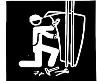
Abdichten der Öffnungen, Fugen, Ritzen, Rohrdurchführungen und offenen Rohrleitungen, die von der Arbeitsstelle in andere Räume führen, mit nicht-brennbaren Stoffen. Geeignet sind z. B. Gips, Mörtel, feuchte Erde oder Lehm. Lappen, Papier oder andere brennbare Stoffe dürfen nicht verwendet werden.
