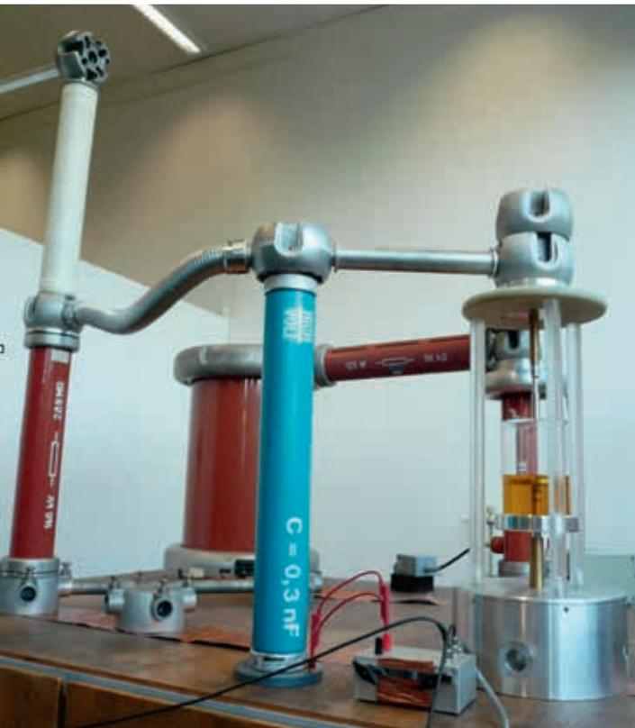
Abb. 4 : Messaufbau für mischspannungsbelastete Isoliertsysteme, hier flüssige Isolierstoffprobe
