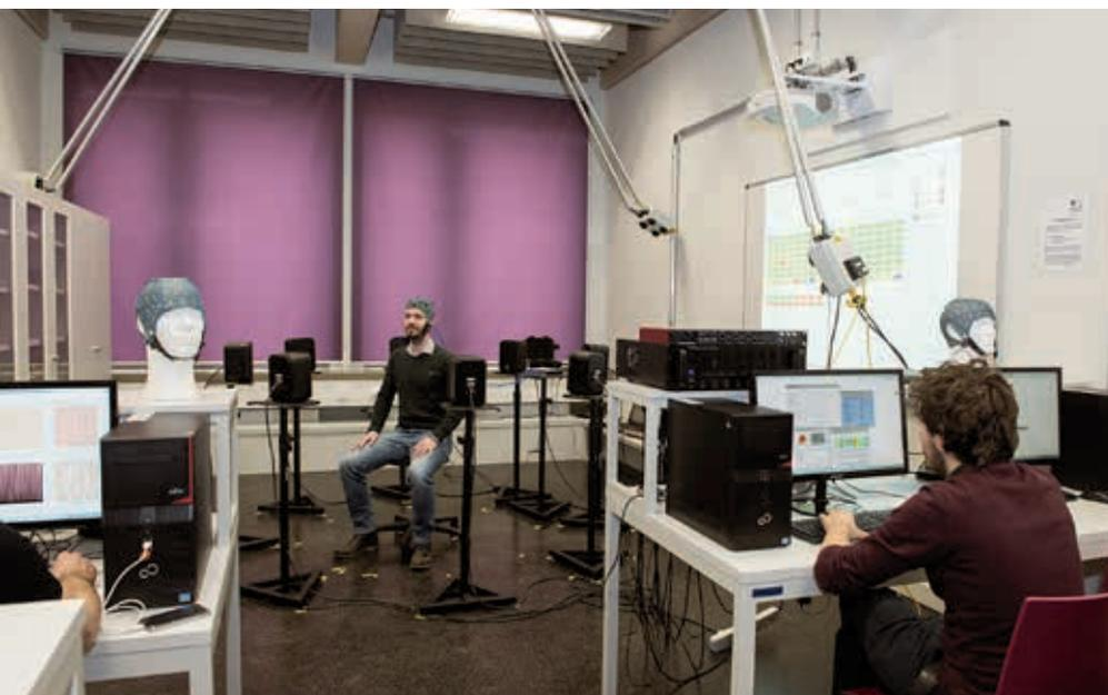
Abb. 2: Audiometrie-Freifeld im MINDSCAN LAB mit EEG-System zur objektiven neurokognitiven Analyse von Hörvorgängen sowie zur neurokybernetischen Steuerung von Hörsystemen (hier Vorarbeiten für das BMBF FKZ 03FH004IX5 „ATTENTIONAL MICROPHONE: Eine aufmerksamkeitskontrollierte Gehirn-Mikrofon-Schnittstelle als Entwicklungsplattform für neurokybernetische Hörsysteme“)
