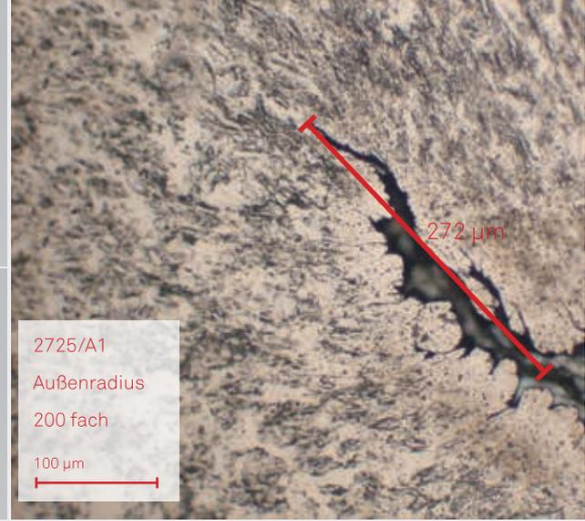
Abb. 2: Querschliff durch ein Prüfteil, das einem umformtechnisch hergestellten Durchzug entnommen wurde. Die technische Umsetzung aus höherfestem Stahl führt zu Inhomogenitäten im Gefüge (Überlegfalten); Quelle: Mercedes
