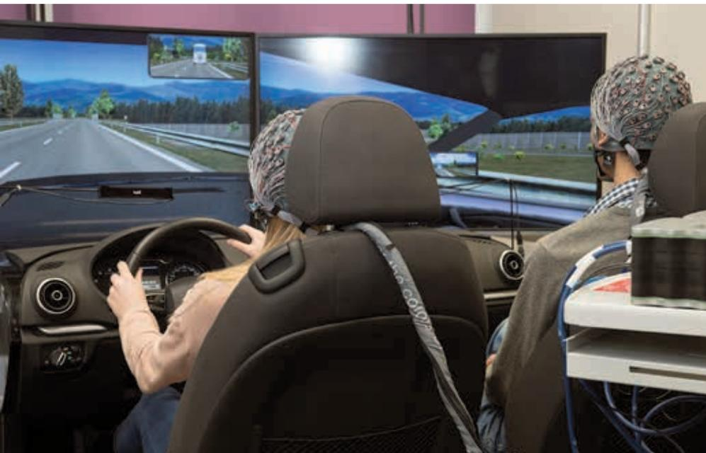
Abb. 1: Fahrsimulator mit einem Kommunikationsinterface einer saarländischen Firma im MINDSCAN LAB. Probanden innerhalb des BMBF-Projekts „NEUROKOGNITIVE AMFS: Neurokognitive Mess- und Simulationsumgebung zum Design auditorischer Mensch-Fahrzeug-Schnittstellen“. Der Simulator verfügt über spezielles HighRes-EEG mit closed-loop control, eyetracking, Pupillometrie sowie eine Reihe weiterer physiologischer Monitore.
