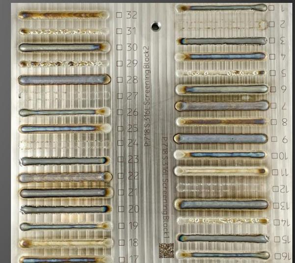
Single-Track Screeningversuche mit Alloy 718 und 316L
