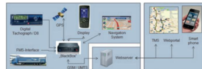
Bild 1: Telematikkomponenten
