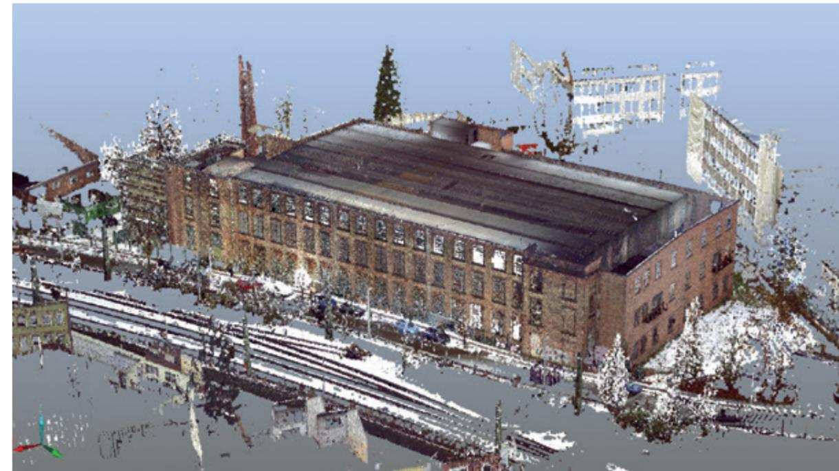
Bild 3 und Bild 2 (oben): Punktwolke als präzise Modellierungsreferenz für 3-D-BIM-Element am Beispiel Notkirche und Baumwollspinnerei
