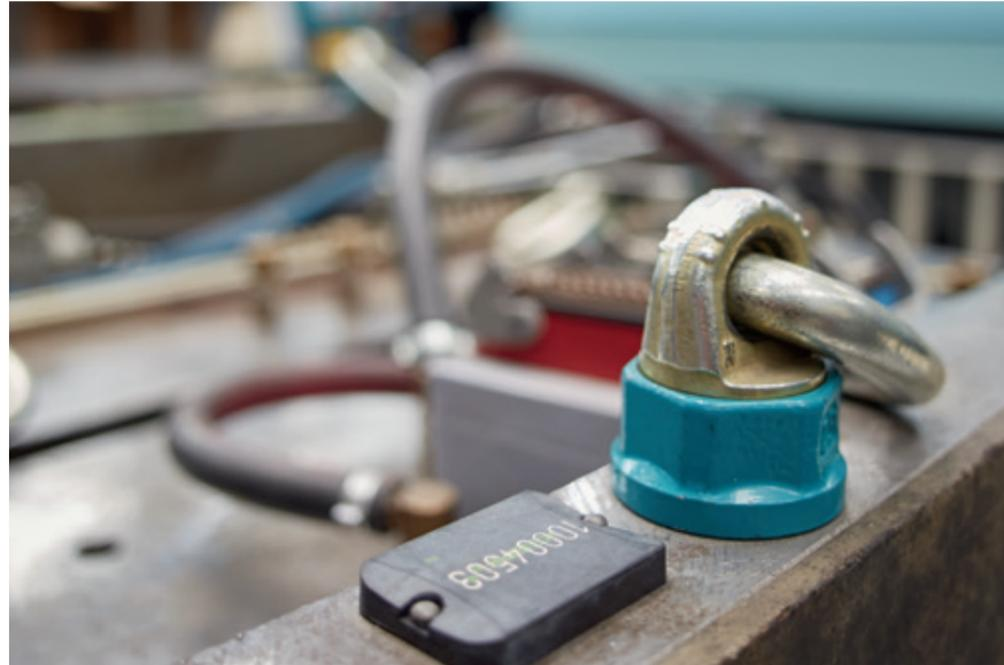
Bild 2: RFID-Tag zur berührungslosen Datenübertragung
