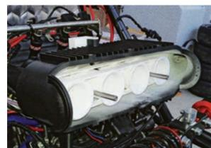
Motorkomponente eines Rennwagens aus dem 3D-Drucker
